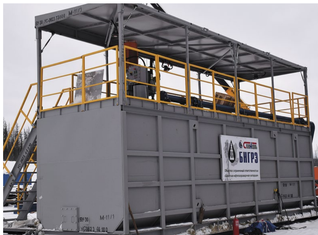
Выносной блок приготовления и диспергации бурового раствора на ТК-79
